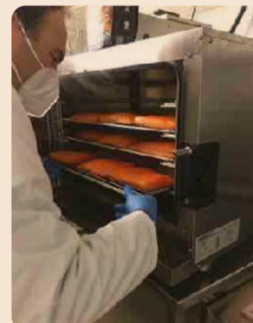
L'impianto pilota di affumicatura ad azoto liquido presso il Rocculi's Lab
